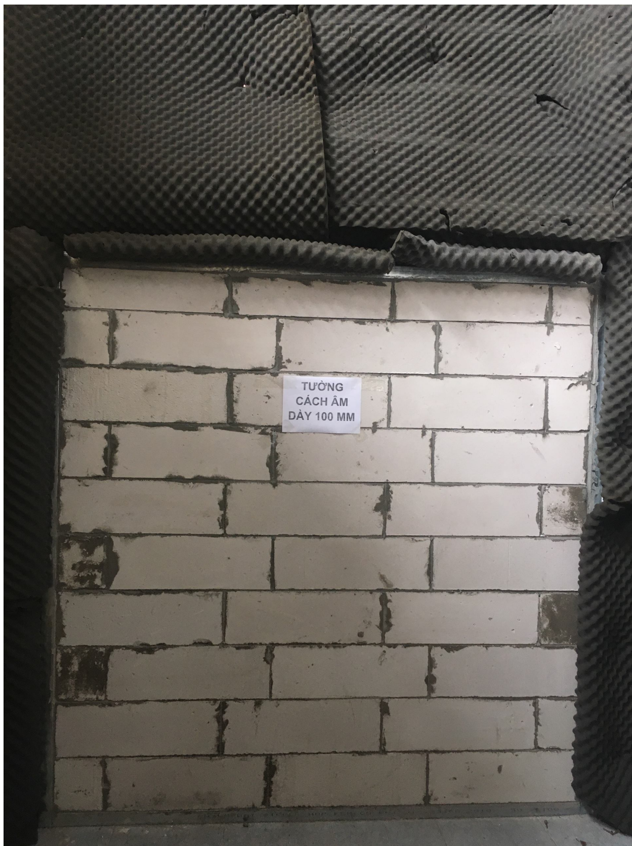
Hình PL.1. Tường gạch bê tông khí chưng áp AAC HASS (loại dày 100 mm)
