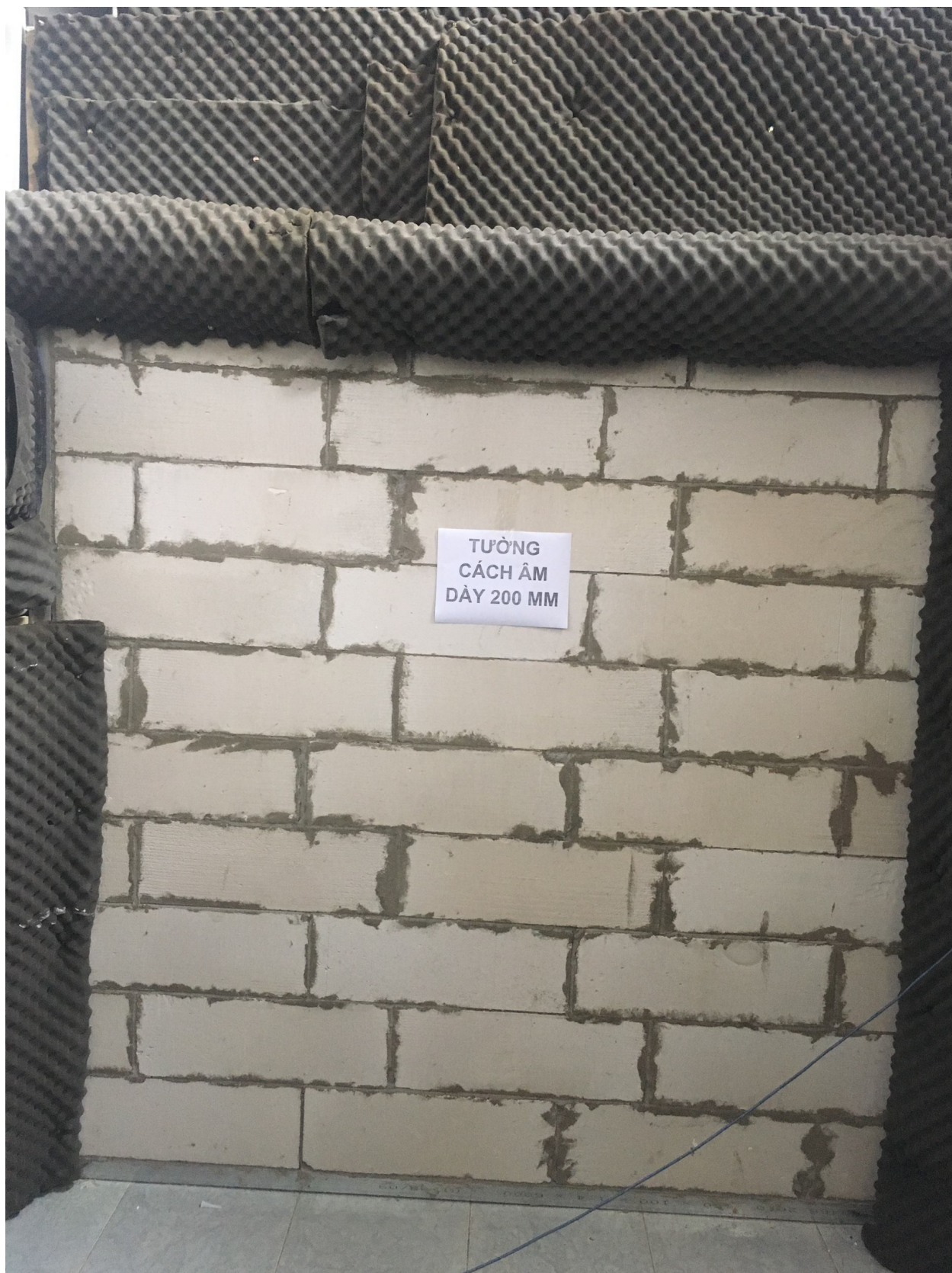
Hình PL.2. Tường gạch bê tông khí chưng áp AAC HASS (loại dày 200 mm)
